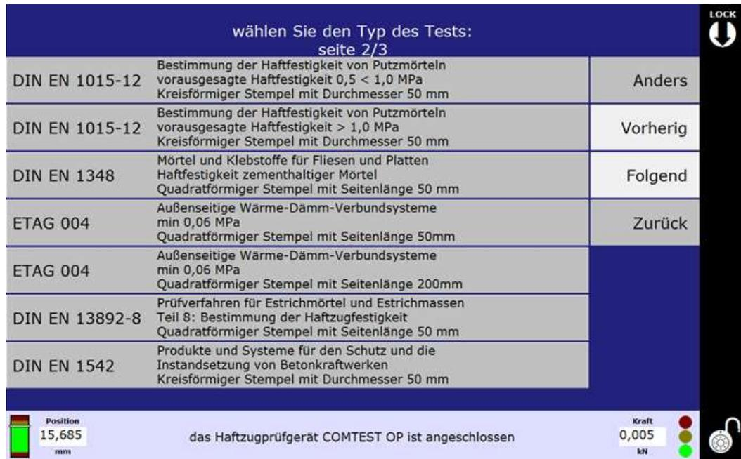
4. An der ausgewählten Prüfnorm kann durch „Änderung“ die Stempelform und die Prüfparameter vorgenommen werden.
